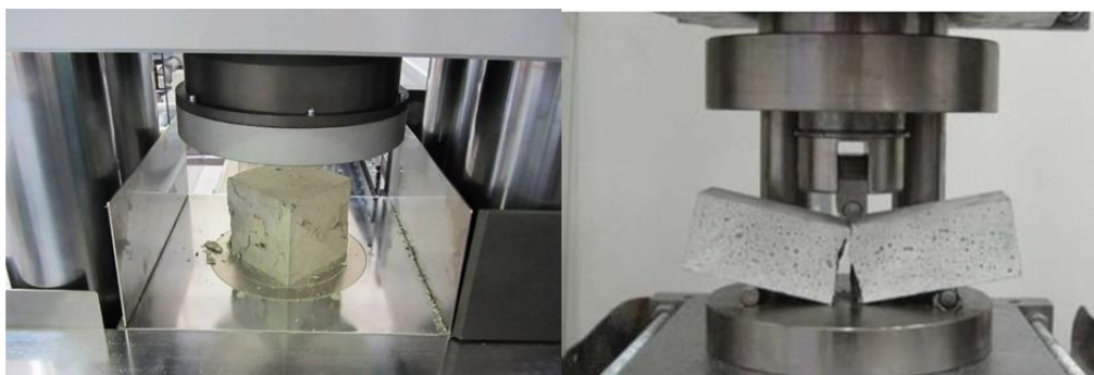
Рис. 1. Проверка прочности бетона при помощи испытаний на гидравлическом прессе
