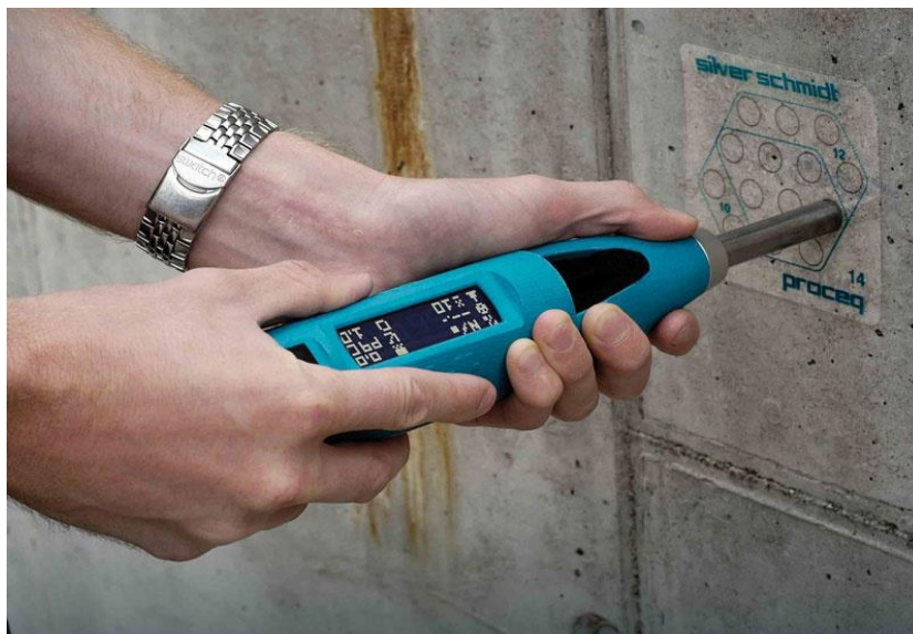
Рис. 3. Метод обратного отскока при определении прочности бетона
