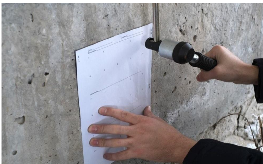
Рис. 5. Метод пластической деформации при помощи молотка Кашкарова
