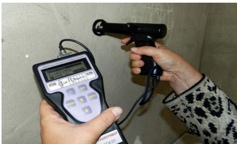
Рис. 2. Ударно-импульсная методика определения прочности бетона
