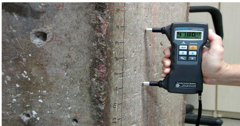
Рис. 4. Ультразвуковое исследование прочности бетона
