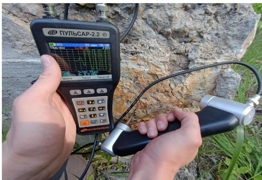
Рис. 3. Определение нарушения монолитности бетона свайно-ростверкового фундамента при помощи ультразвукового прибора ПУЛЬСАР-2.2
