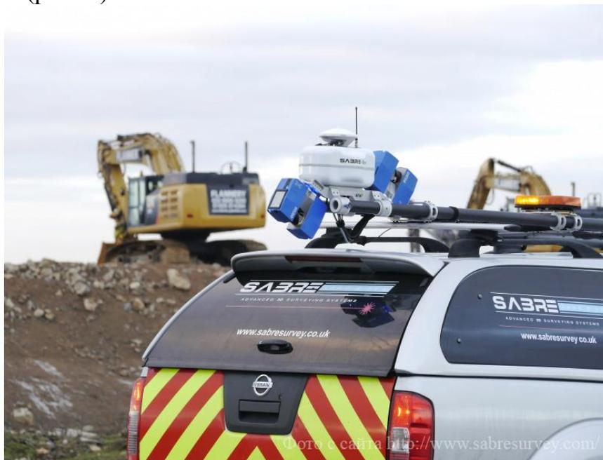
Рисунок - 2. - Наземное мобильное сканирование
