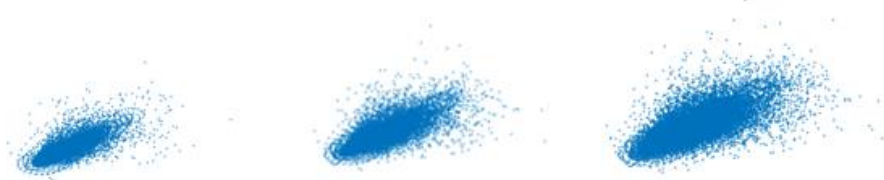
Рисунок 4. Временные фазовые портреты сигнала ВАЭ при трении по оси Y
