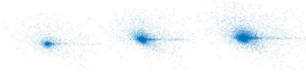
Рисунок 5. Временной фазовый портрет сигнала ВАЭ при трении по оси Z
