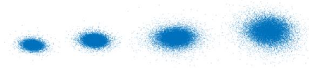
Рисунок 4 - Формирование аттрактора при врезании инструмента в заготовку. Сталь 45, резец ВК8, V=15 м/мин, a=0,2 мм, b=2 мм. Свободное резание.
