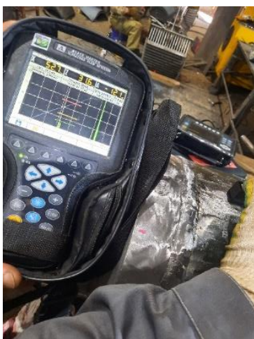
Рис. 3 – Ультразвуковой контроль при помощи дефектоскопа A1212 MASTER
