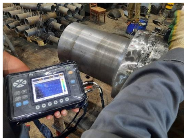
Рис. 4 – Ультразвуковой контроль при помощи высокочастотного ультразвукового томографа A1550 IntroVisor
