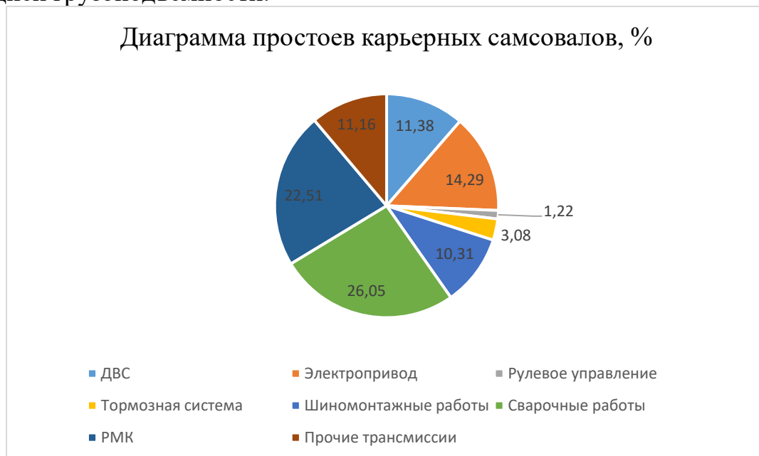
Рисунок 6 Диаграмма причин ремонтных простоев карьерных автосамосвалов
