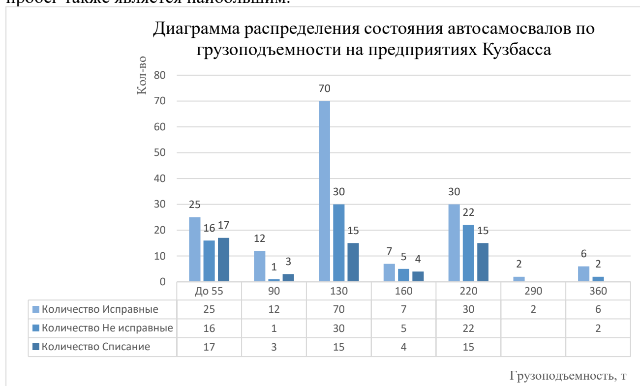
Рисунок 3 Состояние самосвалов разной грузоподъемности на восьми разрезах Прокопьевского района
