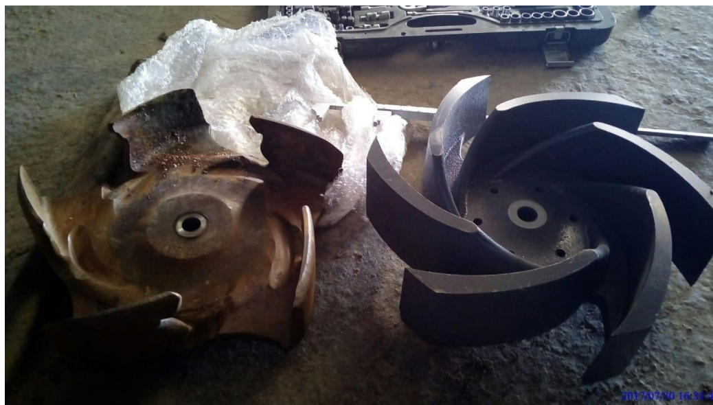
Рисунок 1 - Изношенный и новый шнек.
