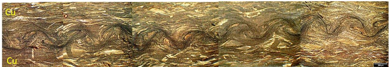
Рис. 3. Микроскопические изображения образца, сваренного под воздействием воздуха.
