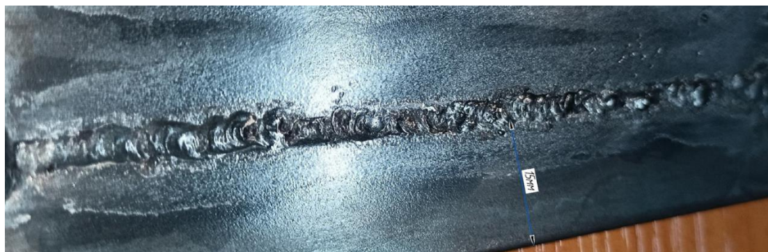
Рис.2 Обратная сторона корня шва, корневой проход выполнен методом РАД с применением флюс-пасты.
