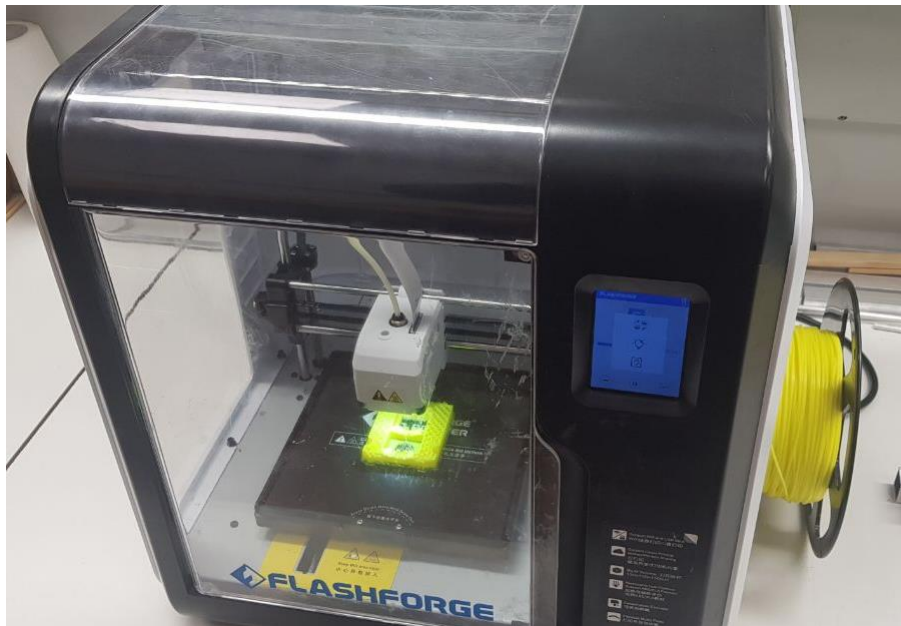
Рис. 2. Процесс печати переходной детали
