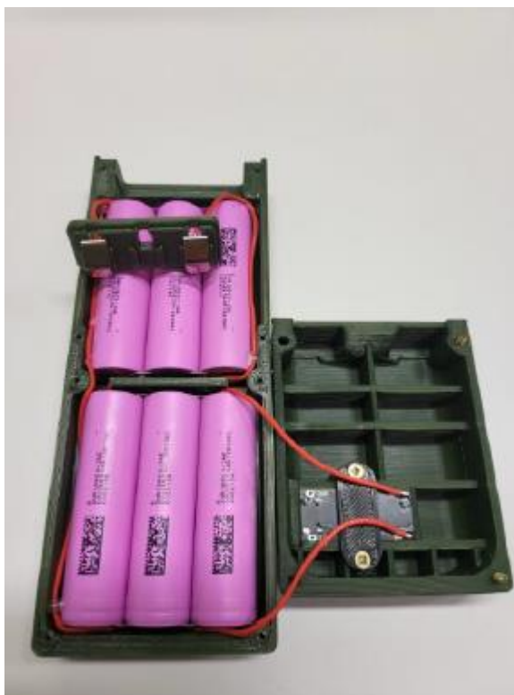
Рисунок 7 – Пайка контроллера питания и контактной пластины
