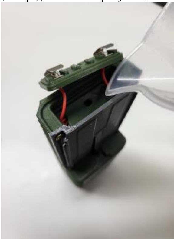
Рисунок 8 – Сборка всех корпусных деталей и элементов и заливка аккумуляторов изолирующим компаундом
