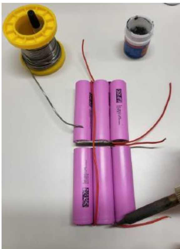
Рисунок 6 – Пайка аккумуляторов в параллельную цепь
