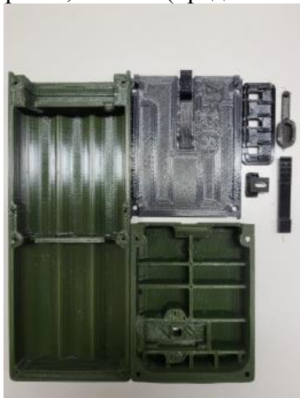
Рисунок 3 – 3D-печать самостоятельно изготавливаемых компонентов
