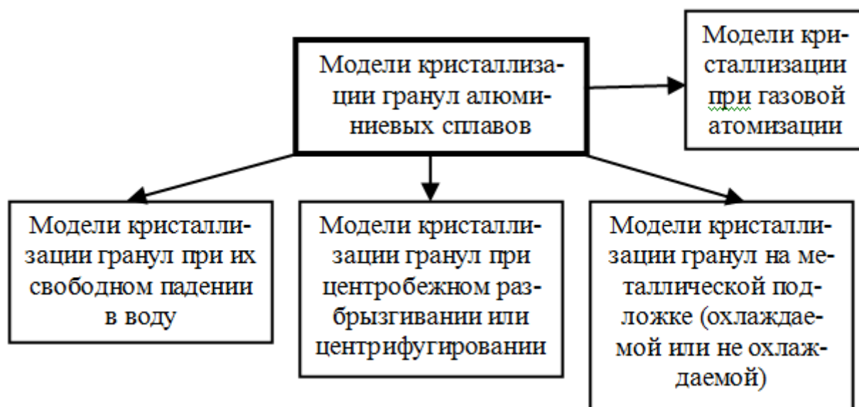
Рисунок 3 – Классификация существующих математических моделей кристаллизации гранул
