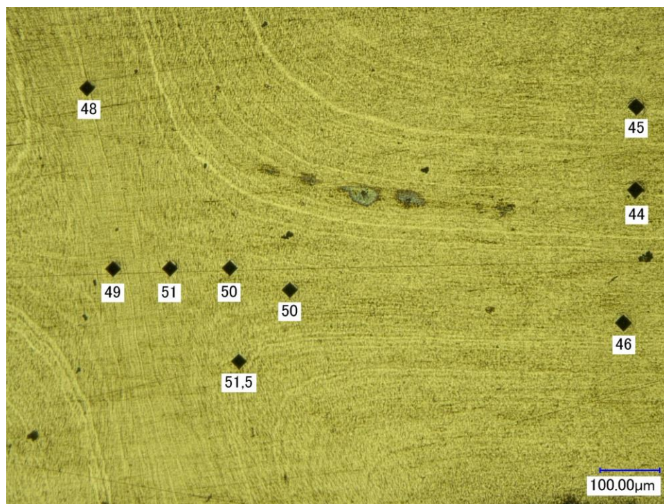
Рисунок 8. Результаты измерения твёрдости (HRC) в различных областях сварного соединения.
