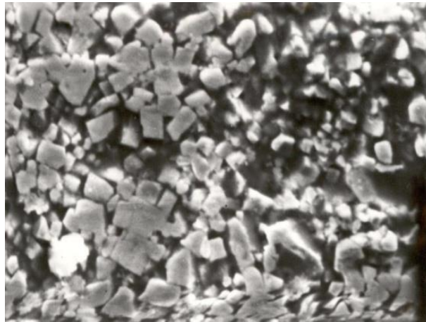
Рисунок 5. Поверхностное разрушение сплава ВК8 после резания стали 45 (×5000)
