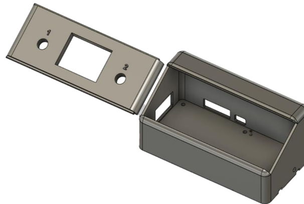
Рисунок 3 – 3D-модель центрального блока
