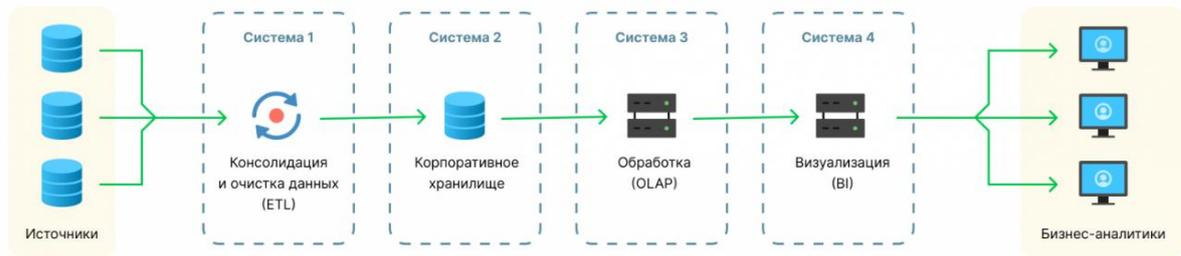
Рисунок 1 – Схема взаимодействия набора технологий
