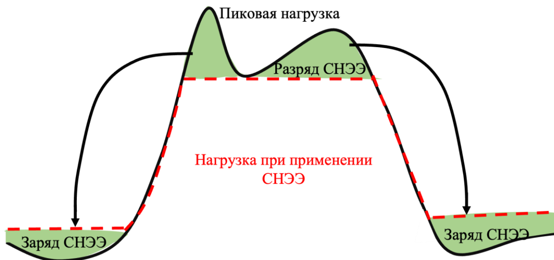
Рис. 1. Выравнивание суточного графика нагрузки с помощью СНЭЭ
