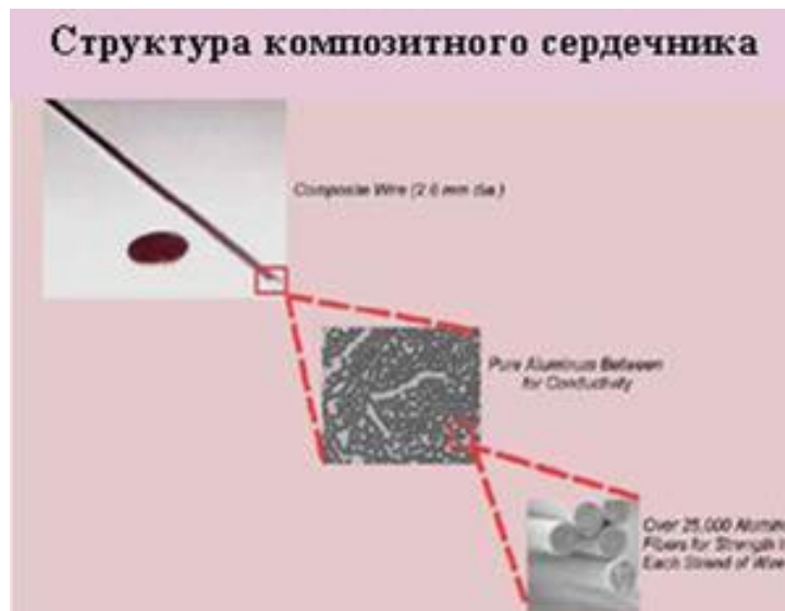
Рис.3. Структура композитного сердечника
