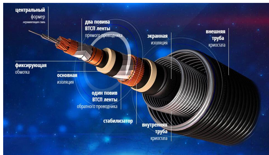
Рис. 1 Схема ВТСП силового кабеля
