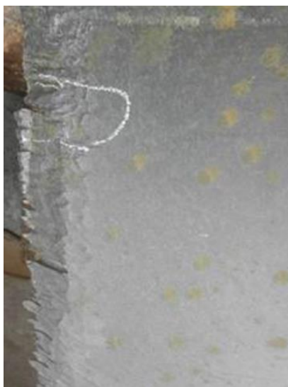
Рисунок - 2 Износ рабочей лопатки после наработки 1800 ч
