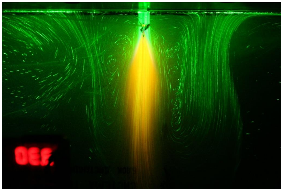
Рис. 5. Формирование симметричных вихревых структур в пламени
