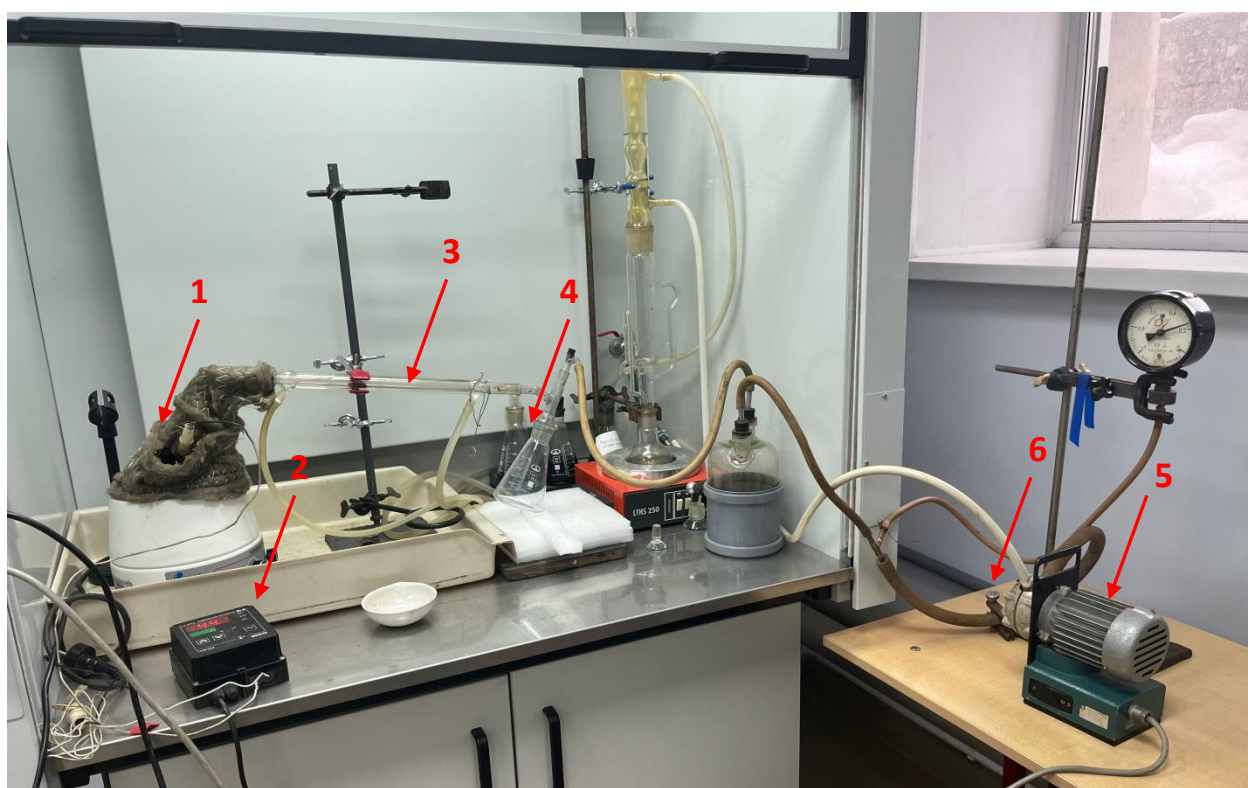
Рисунок 1 – Установка для дистилляции пиролизной жидкости 1– теплоизолированная колба с колбонагревателем, 2 – измеритель регулятор ТРМ1, 3 – холодильник, 4 – сборник жидкой фракции, 5 – вакуумный насос, 6 – регулятор вакуума (дроссель)
