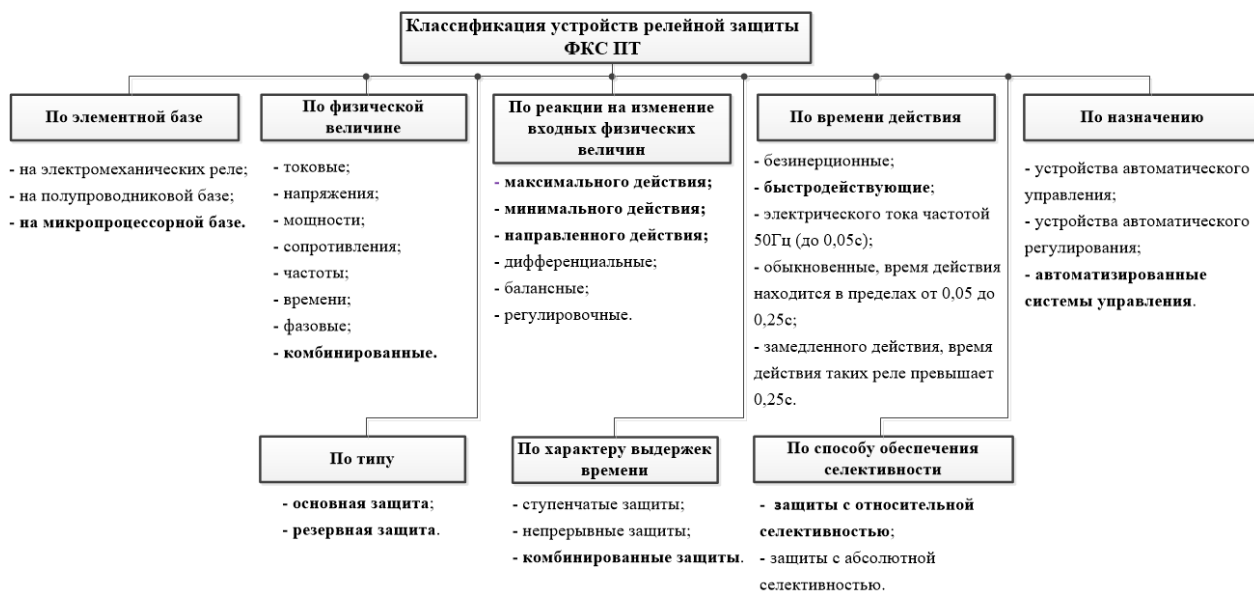
Рисунок 1 - Классификация устройств релейной защиты фидеров контактной сети переменного тока (ФКС ПТ)
