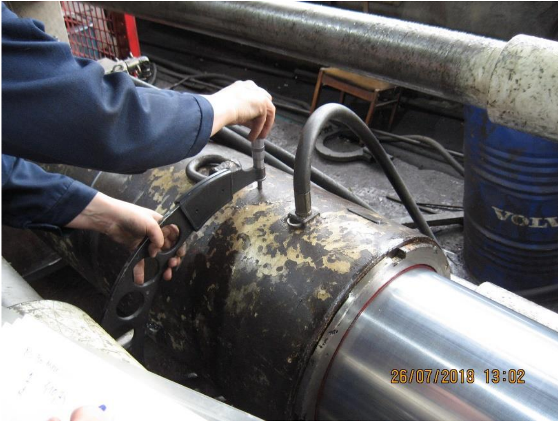
Рис. 2. Измерение внешних диаметров рабочих цилиндров
