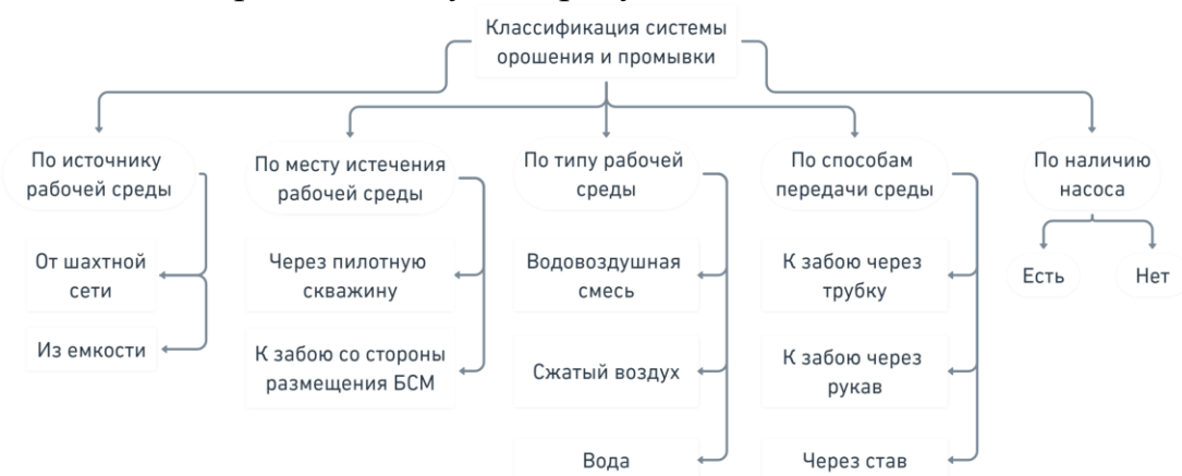
Рисунок 1 – Схема способов подачи жидкости для промывки
