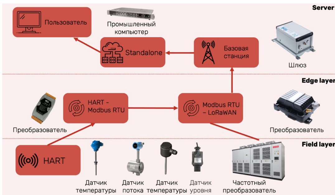
Рисунок 1 – Схема автоматизации насосной установки на основе сети LPWAN.
