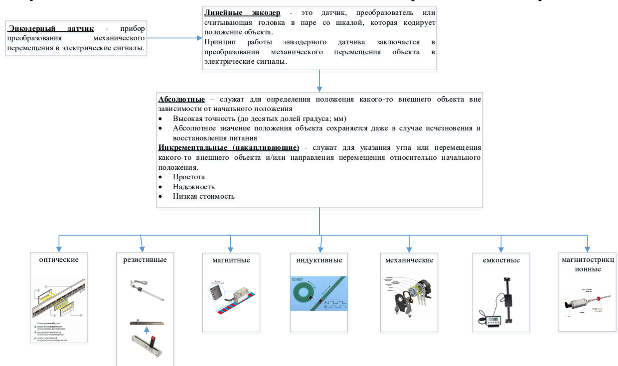
Рис. 2. Классификация энкодерных датчиков перемещений
