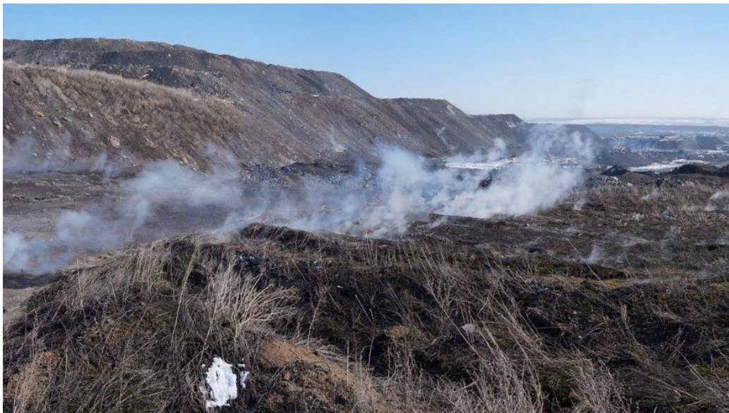
Рис. 1. Эндеогенный пожар на отвалах шахты № 12, г. Киселевск Кемеровской области
