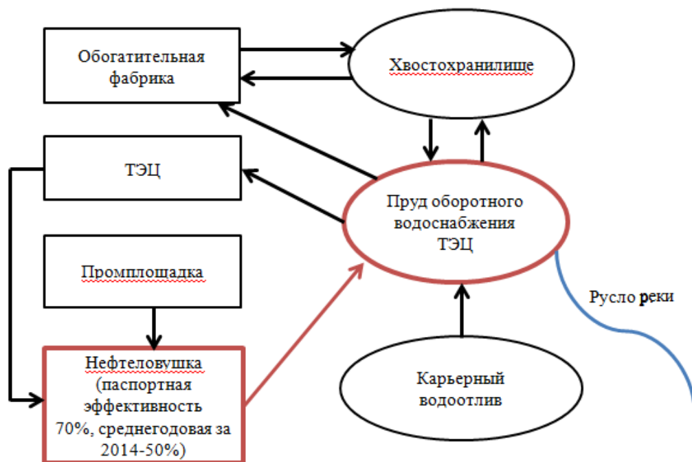
Рис. 2. Существующая система водоочистки горно-обогатительного комбината
