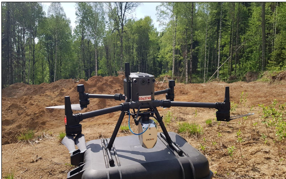
Рис. 2. Сканер СНС АА450, установленный на квадрокоптере Matrice 300
