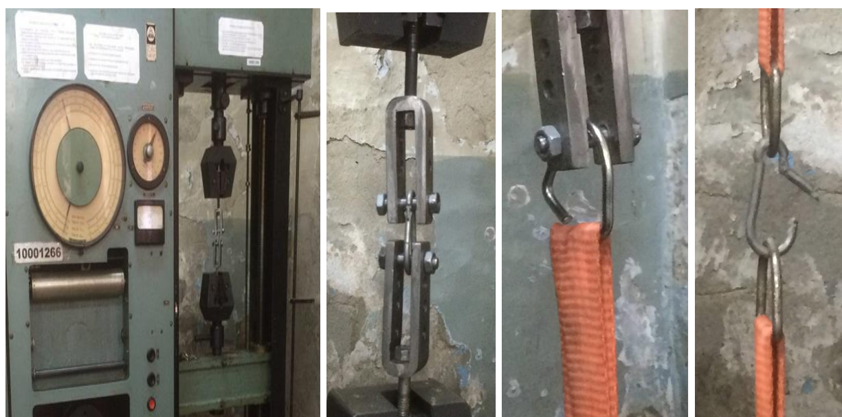
Рис. 5 – Испытание элементов крепежа
