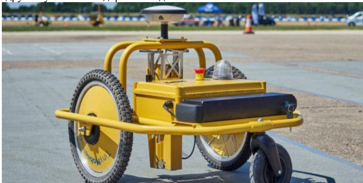
Рис.2. Робот для нанесения дорожной разметки.
