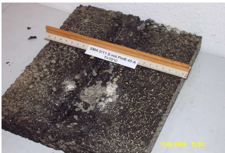
Рис. 4 – Образец после цикла работ по определению глубины колеи
