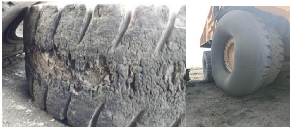
Рисунок 2 –Тепловые разрушения шин
