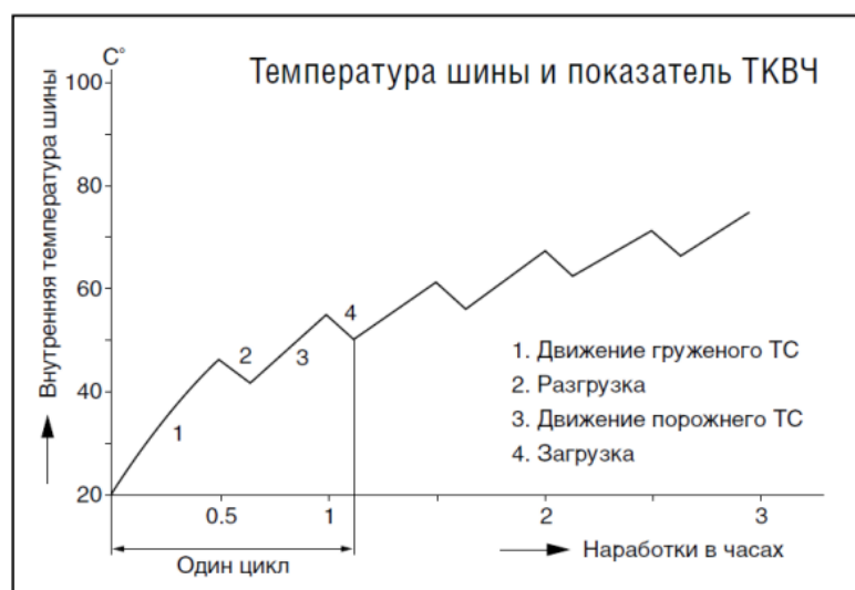
Рисунок 1 – Зависимость внутренней температуры шины от показателя ТКВЧ
