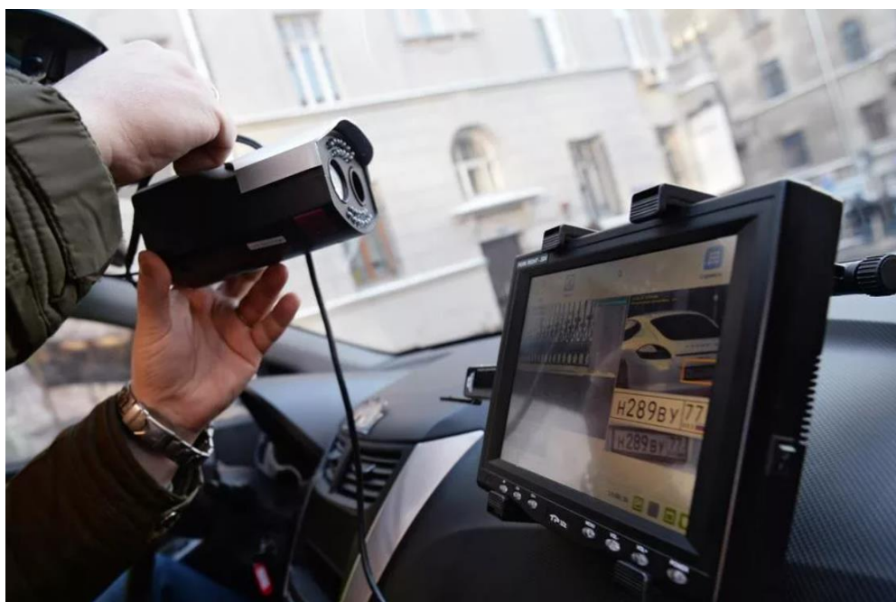
Рисунок 2 – Комплекс для фото-видеофиксации автомобилей
