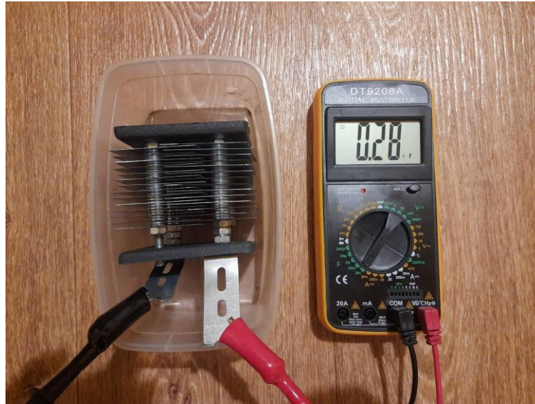
Рисунок 3 – Емкость конденсатора в вакууме
