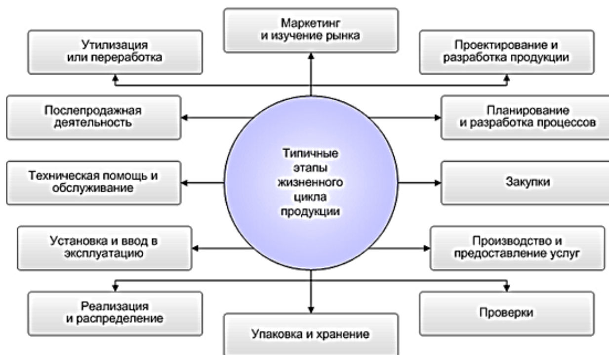
Рис. 1 «Петля качества» на основе типичных этапов жизненного цикла продукции
