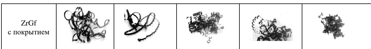
Как видно из таблицы стружка достаточно чувствительна к свойствам передней поверхности, изменяемыми имплантируемым материалом. Так при обработке исходным инструментом получается сливная стружка, причем с увеличением скорости резания она превращается в ленту и сильно запутывается, что нежелательно с точки зрения безопасности и обеспечения качества обработанной поверхности, работоспособности инструмента, производительности (часто приходится останавливать станок для уборки).
