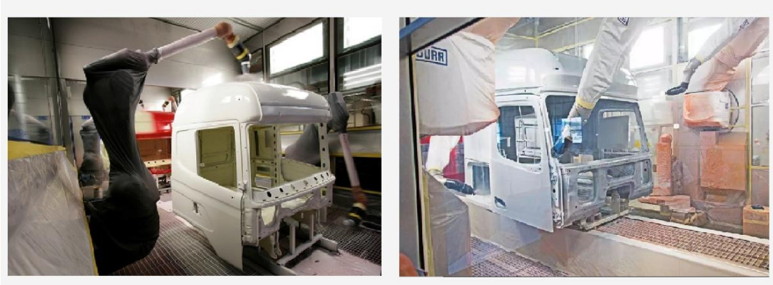
Рис.3 Линия по окраске на заводе КАМАЗ
