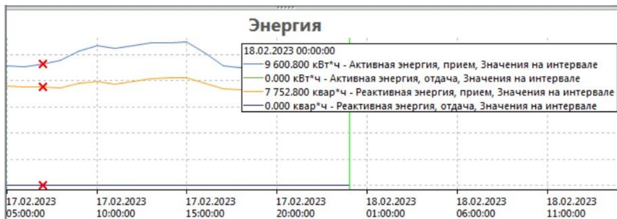
Рис. 1. Суточный график потребления активной и реактивной энергии, представленный программой АРМ «Энергосфера»
