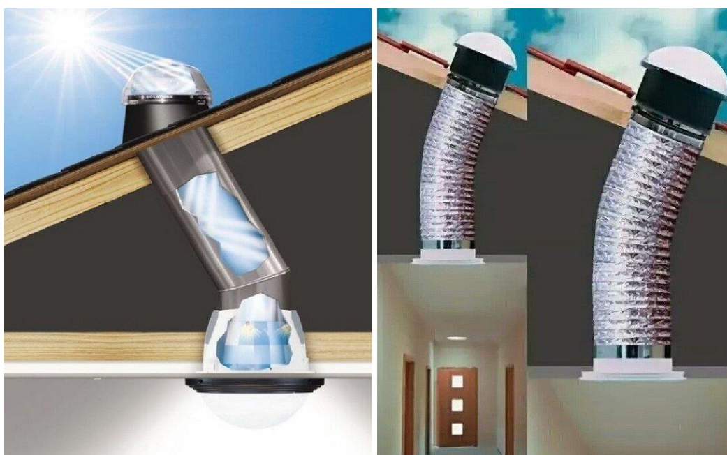
Рисунок 1 – Световой тоннель на крыше здания
