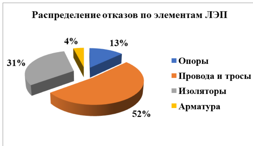
Рис. 1. Распределение отказов по отдельным элементам ВЛ с учетом грозových перенапряжений
