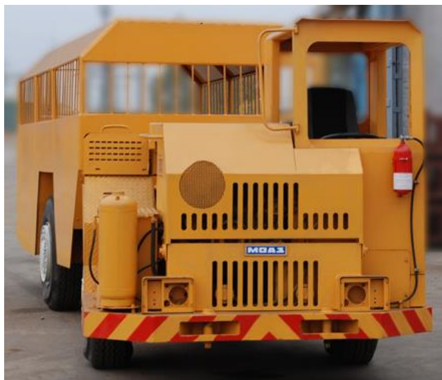
Рис. 9. Подземная машина для перевозки персонала MoA3-59052
