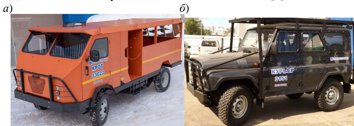
Рис. 1. Машина для перевозки работников рудных шахт: а – серии «КРОТ»; б – серии «КУРЬЕР»
