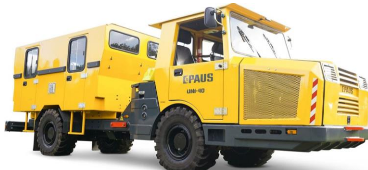
Рис. 3. Машина с пассажирским модулем: а – серии «PAUS UNI 50 РК»; б – серии «PAUS UNI 40 РК»
