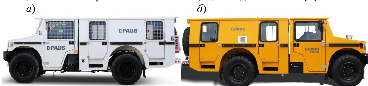
Рис. 2. Модульная машина с пассажирской кабиной: а – серии «Paus MinCa 18 A S»; б – серии «Paus MinCa 18 A PK»
