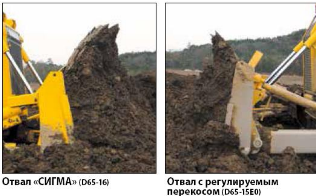
Рисунок 2 – Внешний вид отвалов бульдозера Komatsu: D65-16 «СИГМА»; D65-15E0 (с регулируемым перекосом)
