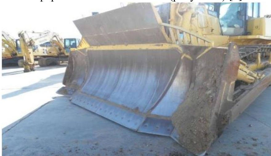
Рисунок 1 – Внешний вид бульдозера Komatsu D65EX-16 с отвалом «СИГМА»
