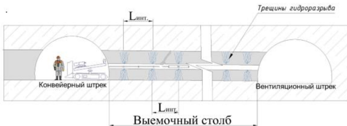
Рисунок 3. Технологическая схема применения метода поинтервального гидроразрыва в скважинах предварительной дегазации выемочного столба.
