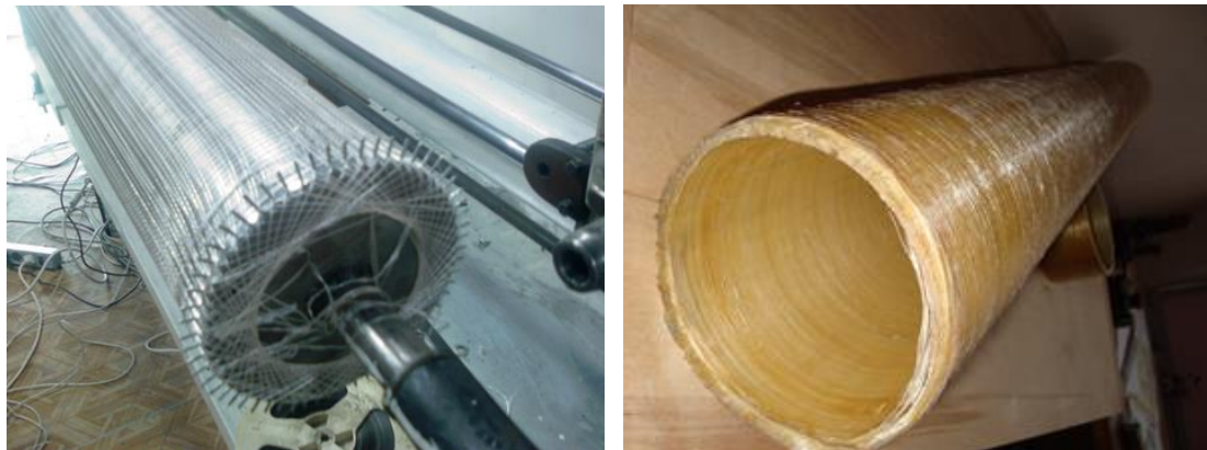
Рисунок 2 Процесс намотки ствольного огнетушителя
