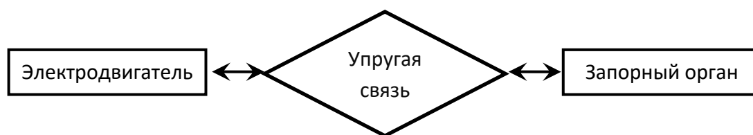
Рисунок 1 – Структурная схема связей электроприводной арматуры
