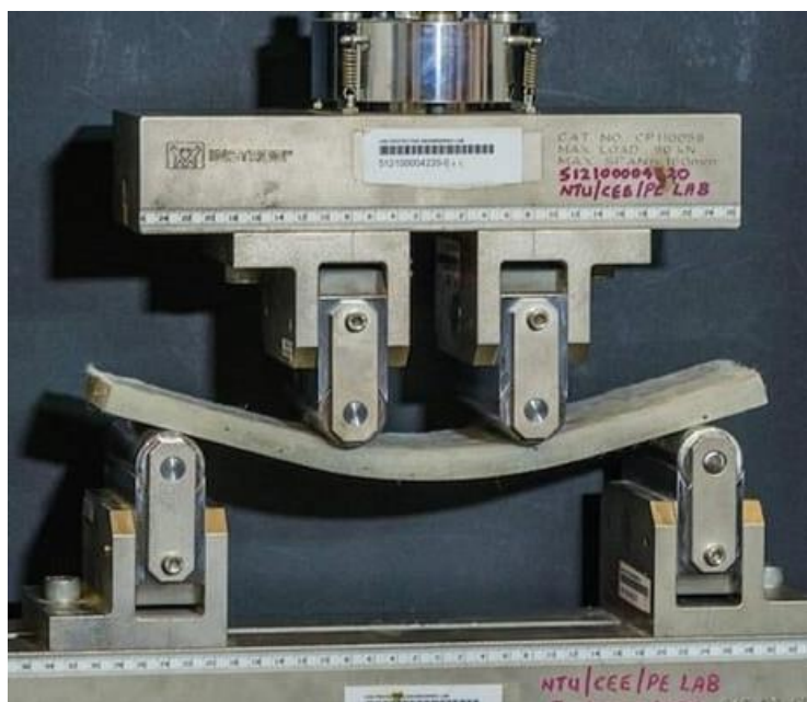
Рис. 2. Испытание гибкого бетона на изгиб под прессом
