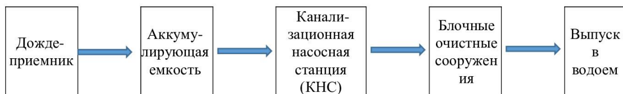
Рис. 1. Схема отвода и очистки поверхностных сточных вод
