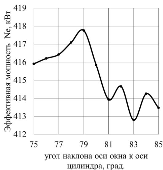
Рис. 4. Зависимость эффективной мощности двигателя-прототипа от угла наклона оси окна к оси цилиндра.
