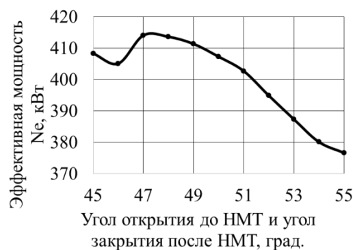
Рис. 2. Зависимость эффективной мощности двигателя-прототипа от углов открытия и закрытия продувочных окон.
