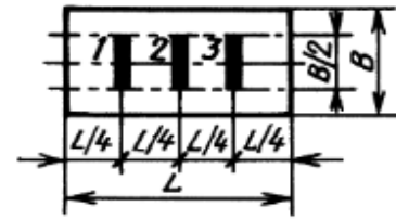
Рисунок 4. Схема отбора проб из автомашин
