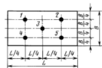
Рисунок 2. Схема отбора проб из автомашин
